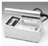
空間線量測定用 NaIシンチレーションサーベイメーター (ALOKA製 TCS-172B) 保有台数：4台 貸出可能期間：原則1週間
