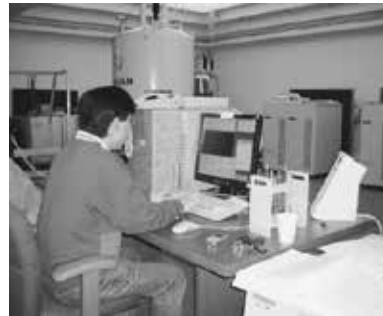
写真12：600MHz (14.1T) のNMR装置を用いた実験風景。細胞から抽出した液体をNMRチューブに詰め、この装置で代謝物の測定を行っていた。1本の測定に最低でも数時間必要で、使用料が時間単位で課金されるので測定が終わるたびに深夜休日間問わずに大学に行って測定を繰り返していた。
