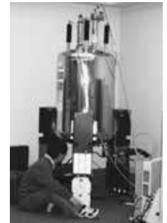
写真12：600MHz (14.1T) のNMR装置を用いた実験風景。細胞から抽出した液体をNMRチューブに詰め、この装置で代謝物の測定を行っていた。1本の測定に最低でも数時間必要で、使用料が時間単位で課金されるので測定が終わるたびに深夜休日間問わずに大学に行って測定を繰り返していた。
