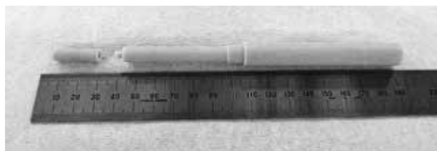
Fig4. Farmer型形状の蛍光ガラス線量計装填用ファントム
