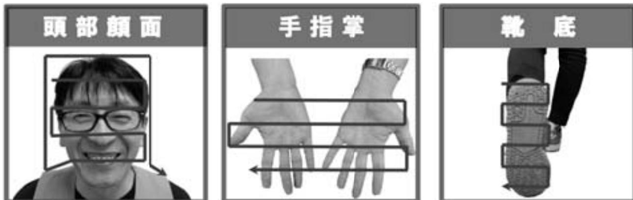
(Fig.1) 住民指定箇所検査の測定部位と測定方法
